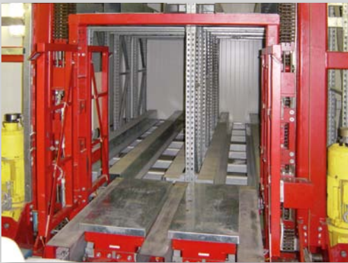
RFZ mit Kanalfahrzeug für Spezialpaletten von 500 - 2000 kg Belastung
